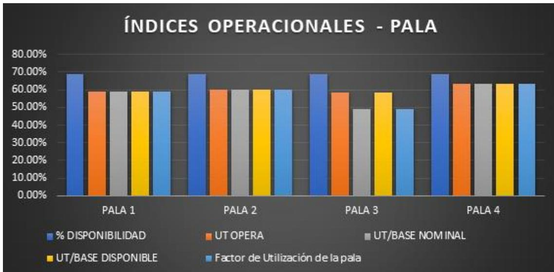
Figura N°3: Índices operacionales pala en circuito 53 camiones con aumento de velocidad fuera del pit 10%.
